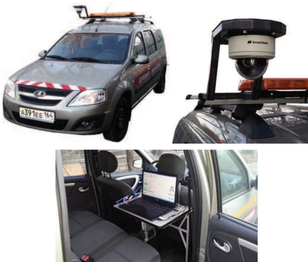
Рисунок 8 – Измерительный комплекс – передвижная дорожная лаборатория КП-514СМП на базе автомобиля «LADA Largus»
